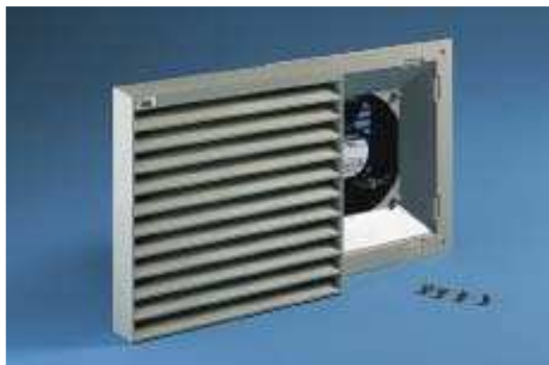
Ventilatore/filtro 250 x 250 mm 95 mc/h - 230 Vca - 50/60 Hz. AX 261
